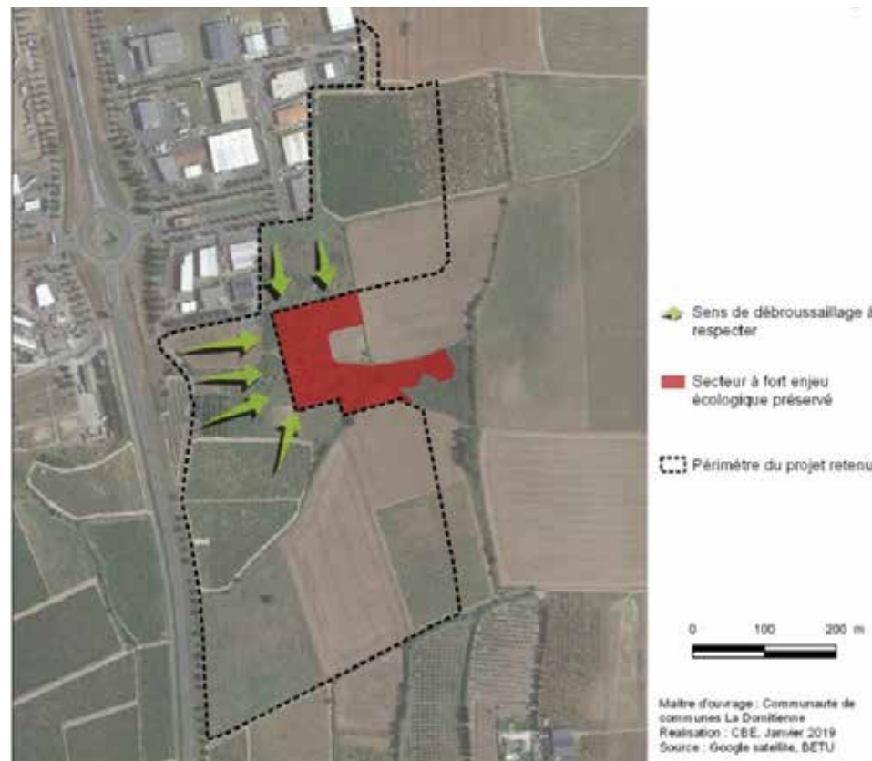
Carte 34 : sens de débroussaillage à respecter lors du démarrage des travaux
